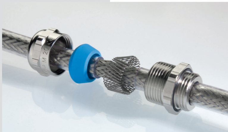
Abb. 2: Bei der EMV-Kabelverschraubung blueglobe TRI® kontaktiert die Triangelfeder das Kabelschirmgeflecht sicher um 360°.
