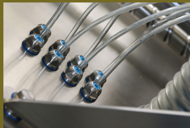
Die Kabelverschraubung blueglobe CLEAN Plus® punktet in Sachen Hygiene und Optik, wie hier an der Einführungsstelle von Pneumatikleitungen einer aktuellen Weber-Maschine. Das Pneumatikaggregat sitzt geschützt hinter der Edelstahlabdeckung. (Bild: Lutz)
