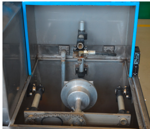
Blick in die IPx9K-Prüfanlage
