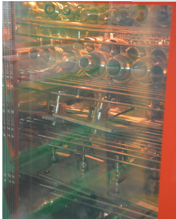
Blick in die mit aufgebauten Prüflingen gefüllte Klimakammer
