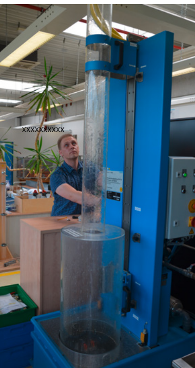
IP X5/6-Prüfanlage mit Strahlwasser-Prüfung
