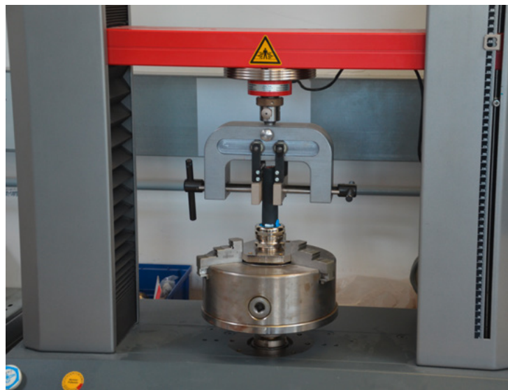
Aufbau eines Prüflings mit Kabel in der Prüfanlage für statische und dynamische Zugprüfung
